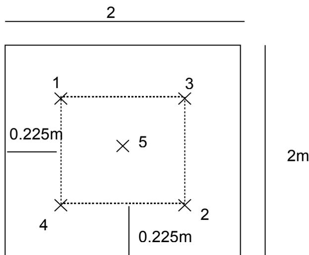
Figure 1.1-a : Positionnement des câbles dans la poutre
