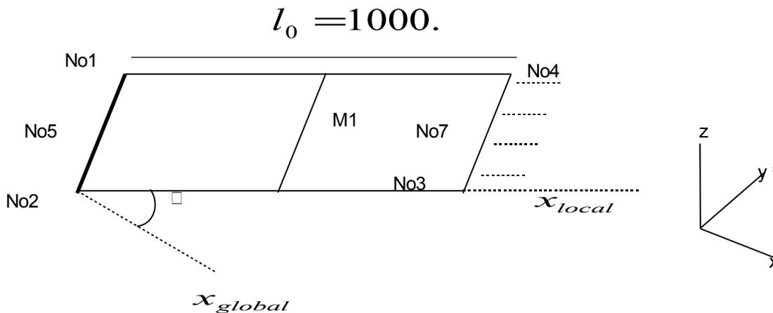
On appelle  $l$  la longueur de la plaque déformée, on notera  $x, y, z$  les coordonnées de la configuration déformée et  $X, Y, Z$  les coordonnées de la configuration initiale
