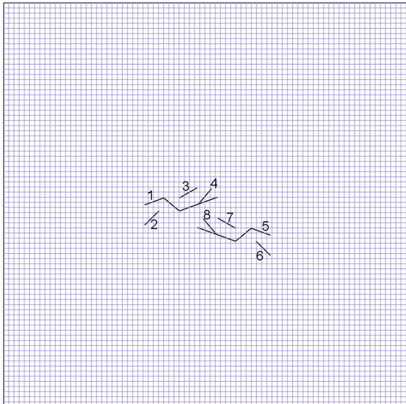
Figure 3 : maillage initial et numérotation des fissures.
