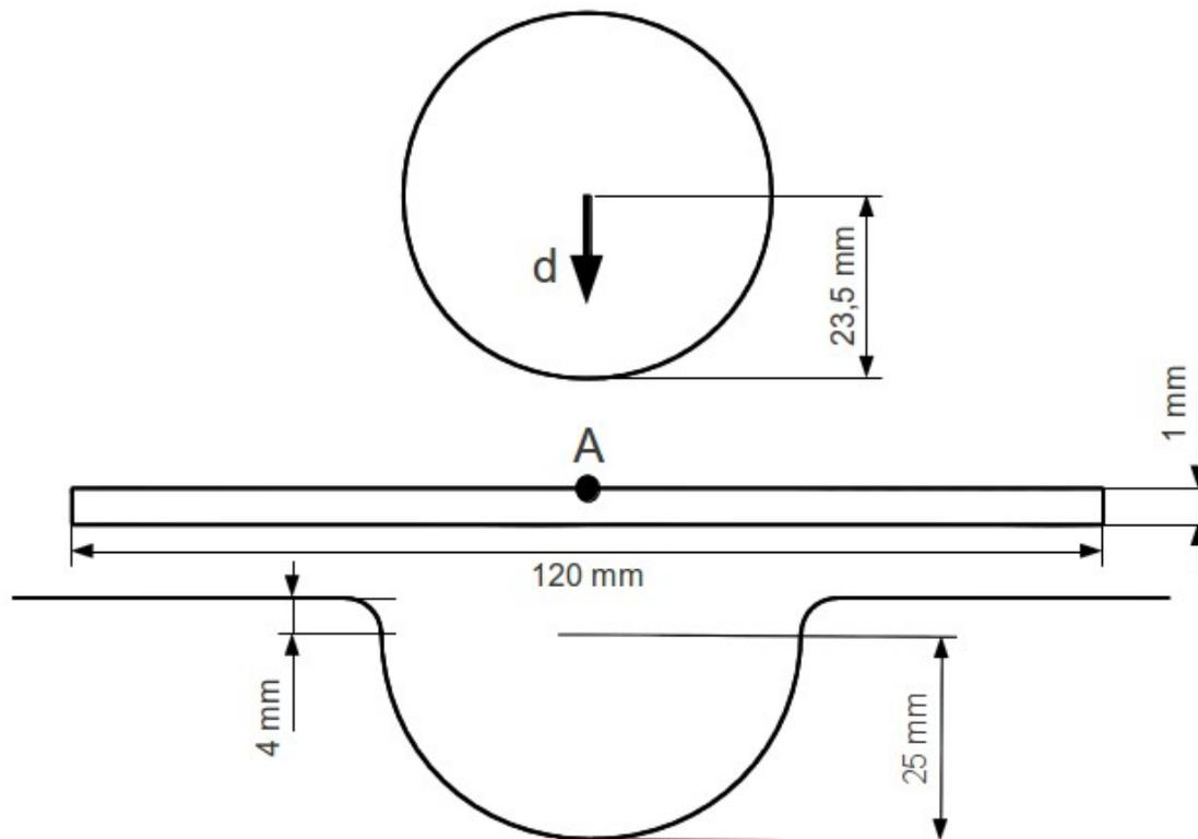
On note  $A$  le point milieu de la plaque situé sur le bord supérieur.
