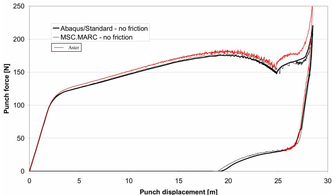
Les résultats obtenus en quadratique sous-intégré sans frottement avec la formulation discrète sont en bon accord avec la solution de référence.
