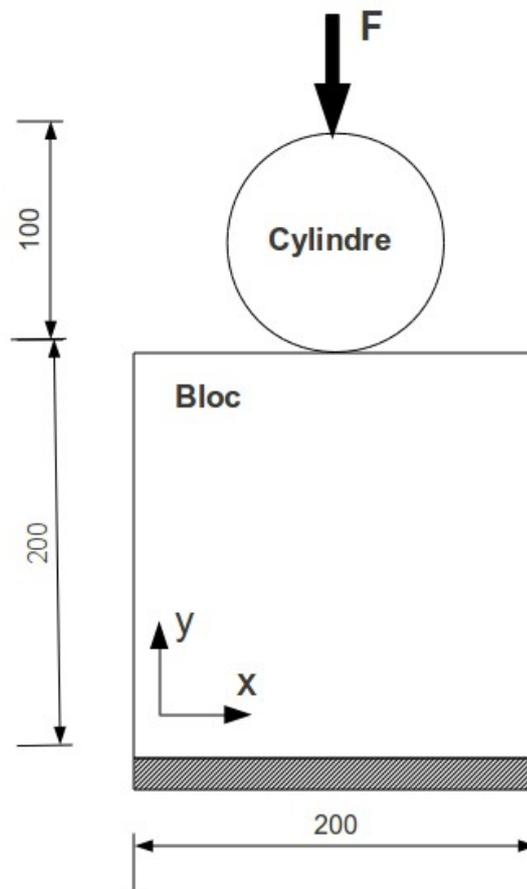
On note  $B$  le point du côté supérieur du bloc appartenant au plan de symétrie.
