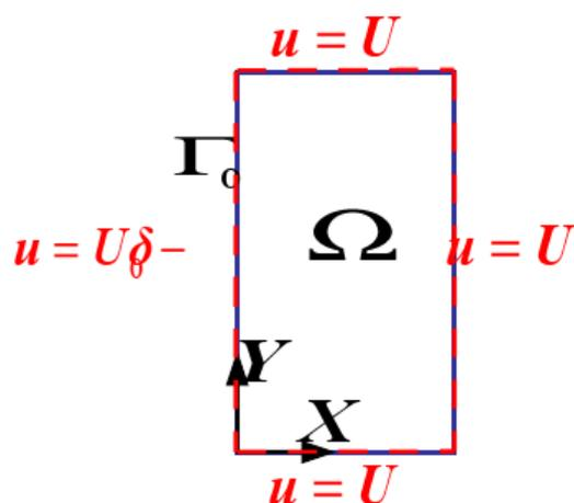
Figure 1.3-a : Schéma du chargement
