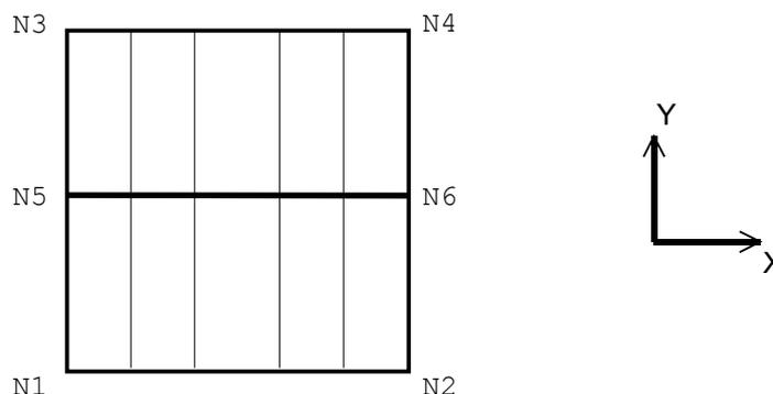
La plaque de béton est représentée par 10 éléments DKT, supportés par 10 mailles QUAD4.
