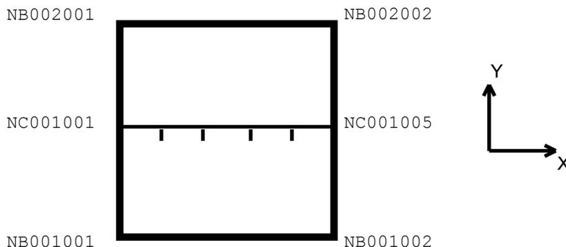
La plaque de béton est représentée par un élément DKT, supporté par une maille quadrangle à 4 nœuds.
