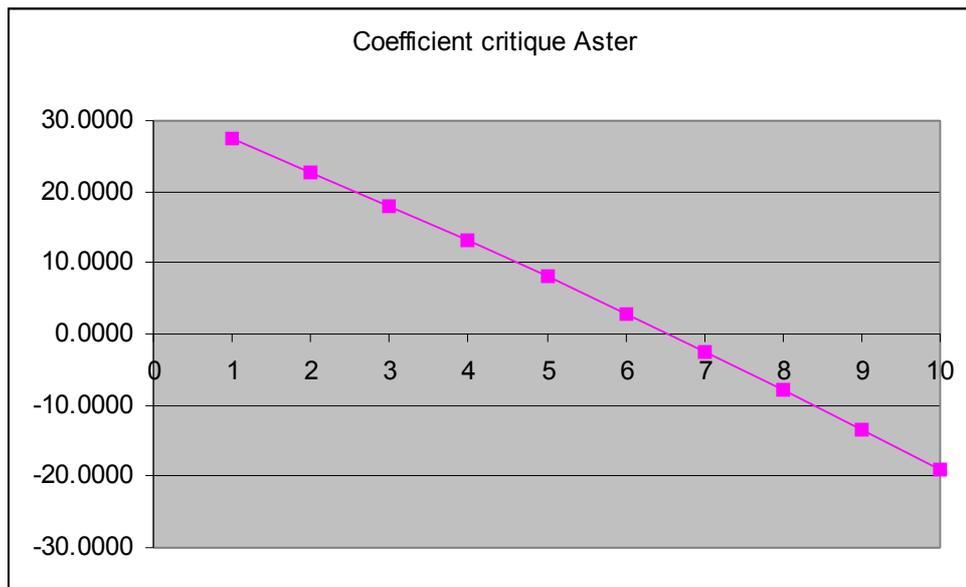
En élastoplasticité, on teste les instants où le coefficient critique change de signe. Les tests sont de non régression puisque l'on ne dispose pas de solution analytique dans ce cas.
