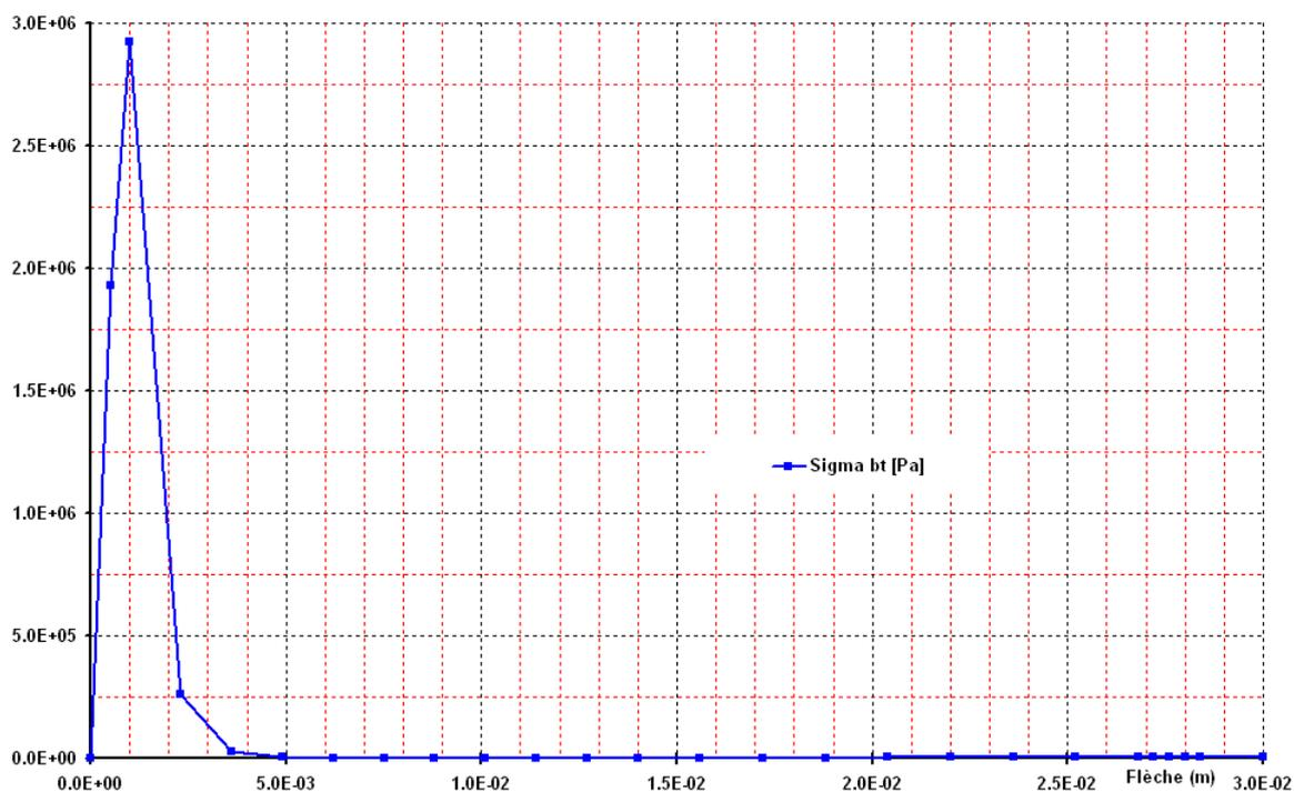
Figure 3.2-contrainte béton tendu, en fonction de la flèche au centre.
