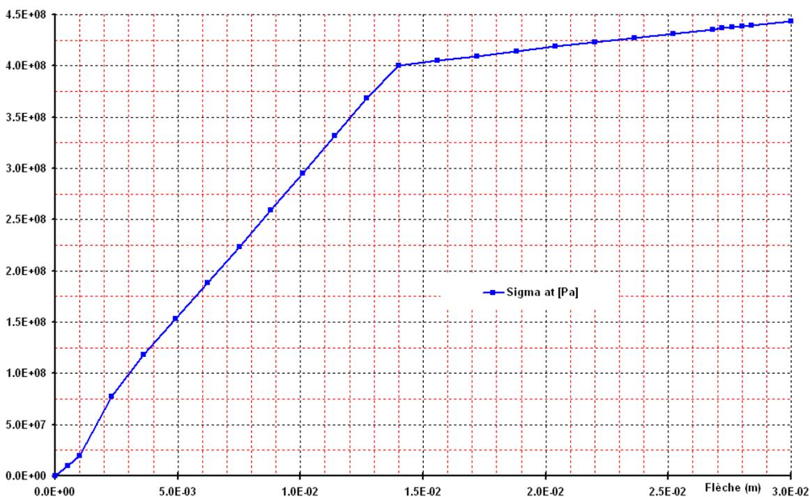
Figure ontrainte acier tendu, en fonction de la flèche au centre.
