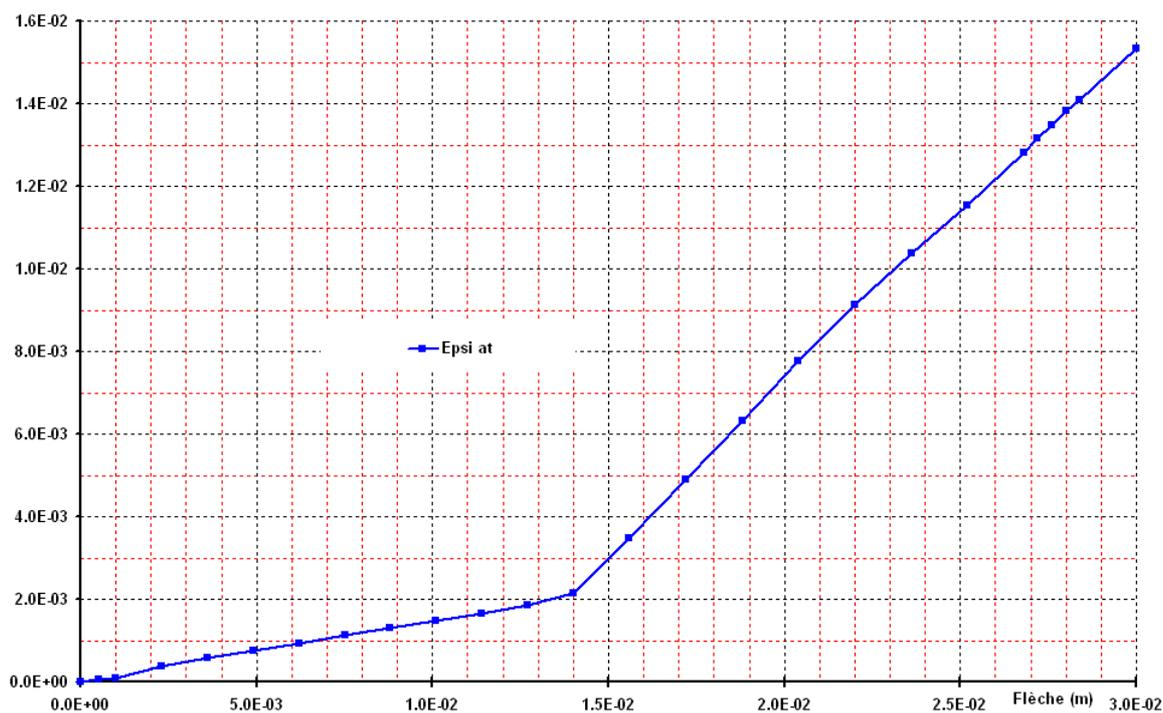
Figure : déformation des aciers tendus, en fonction de la flèche au centre.
