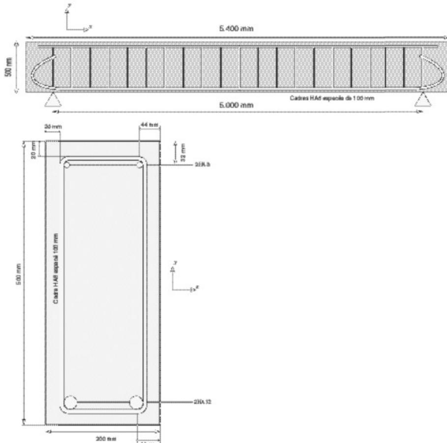
Figure 1.1-a : plan de la poutre.
