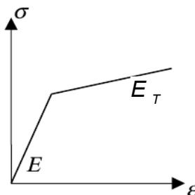
Figure ourbe de contrainte – déformation de l'acier
