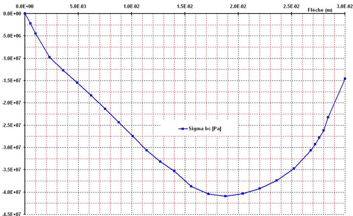
Figure 3.2-dontrainte béton comprimé, en fonction de la flèche au centre.
