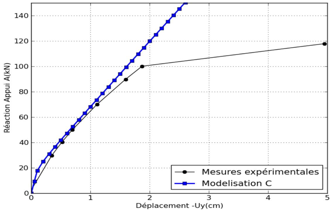
Figure 5.2-a : réaction sur un appui, en fonction de la flèche au centre
