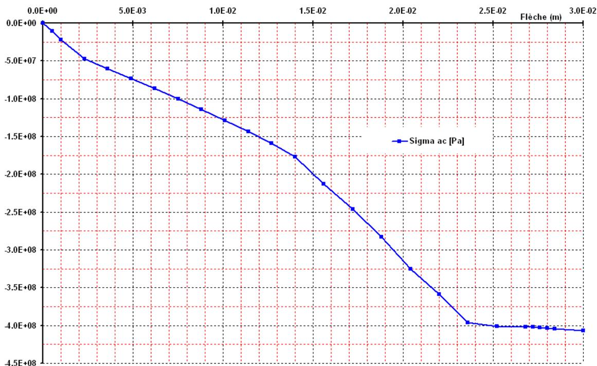
Figure3.3-aontrainte acier comprimé, en fonction de la flèche au centre.
