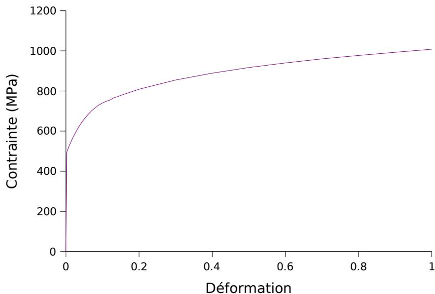
**Figure 2** : Courbe d'écroissage isotrope du matériau volumique.
