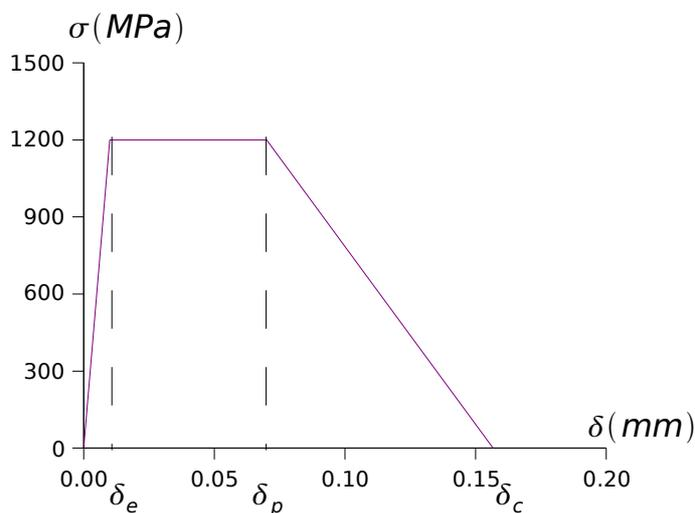
**Figure 3** : Loi de comportement des éléments d'interface.
