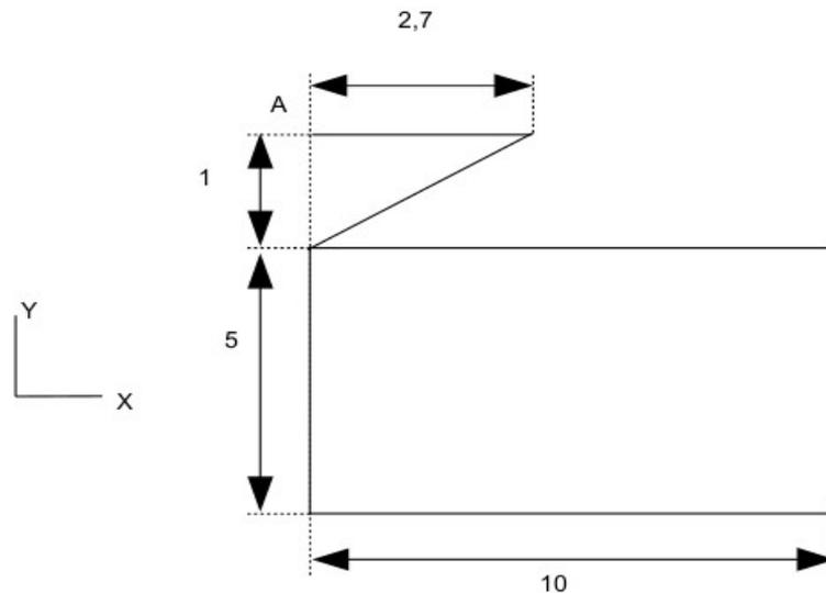
Le problème est axisymétrique (d'axe  $Y$ ). Le poinçon est constitué d'un seul élément triangulaire. Il est supposé en contact initial avec le massif au point  $A$ , ce point est donc topologiquement confondu entre le poinçon et le massif.
