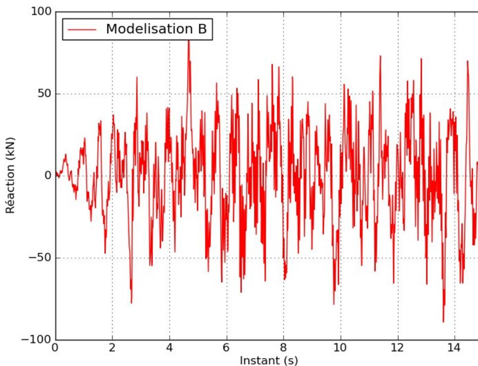
Figure : réaction d'appui en A en fonction du temps, pour 15 secondes.
