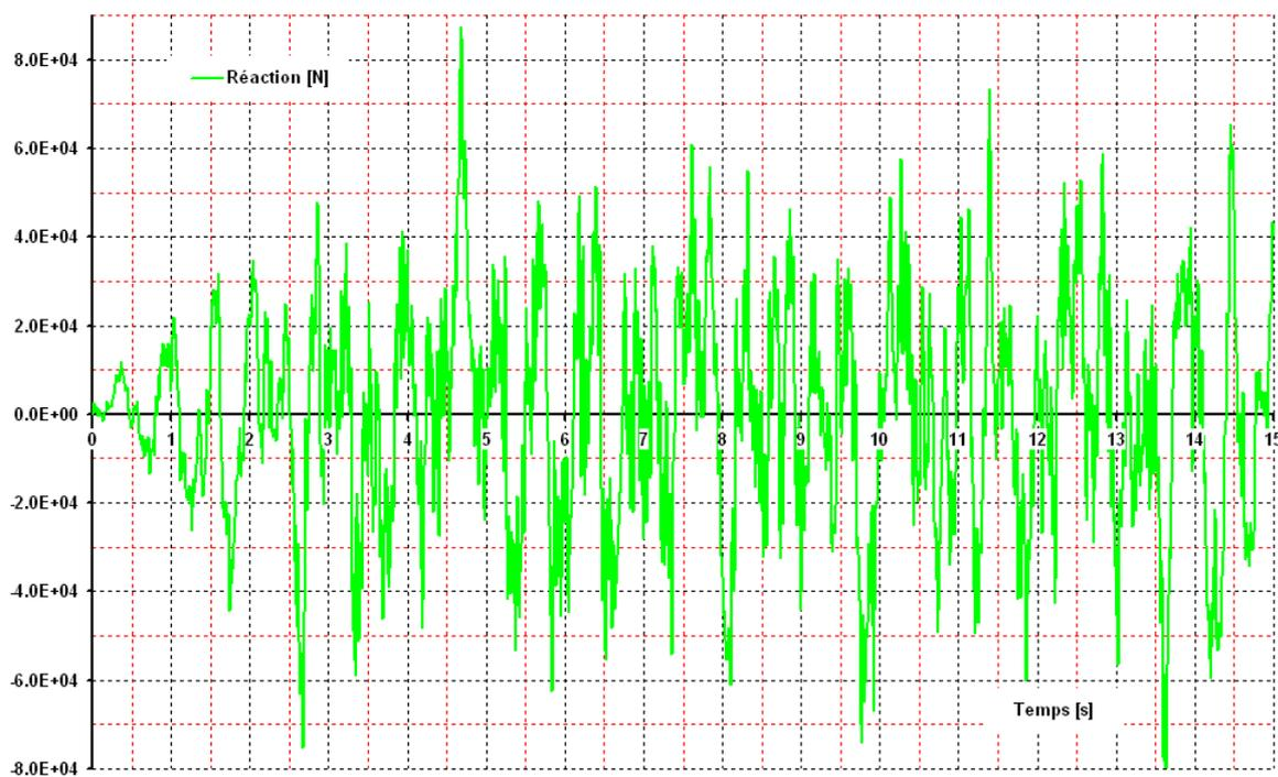
Figure 3.2-déaction d'appui en A en fonction du temps, pour 15 secondes.
