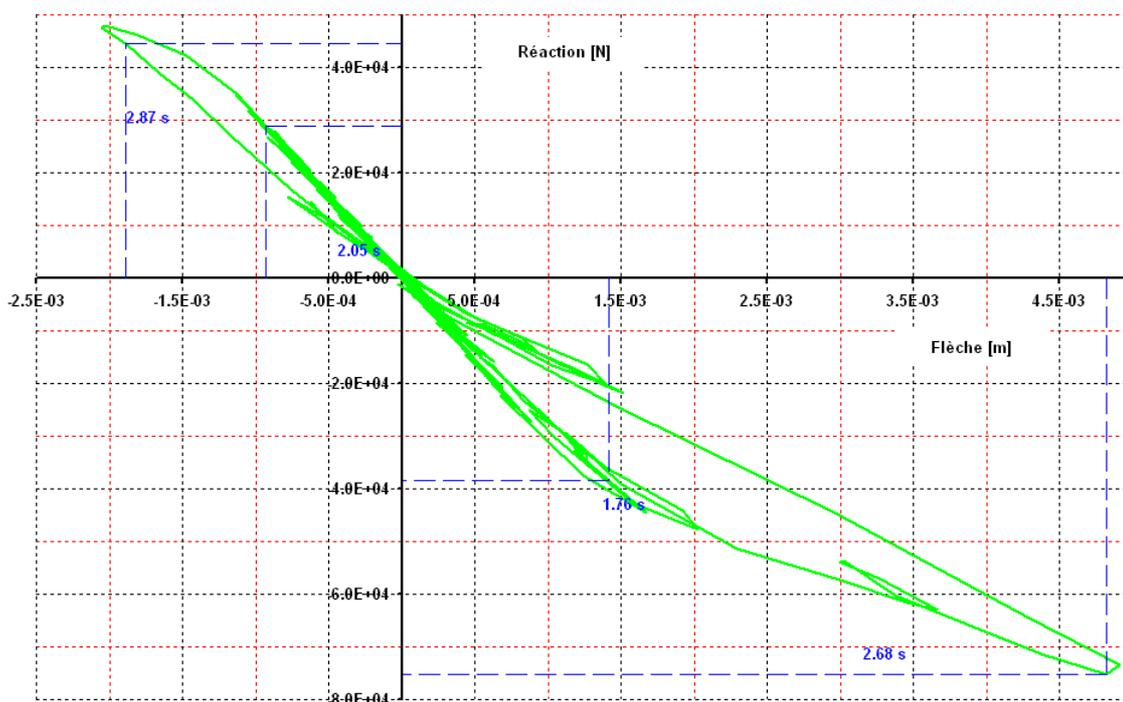
Figure 3.2-c : courbe réaction-flèche pour les trois premières secondes.
