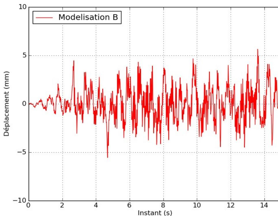
Figure 4.2-e : fèche au centre en fonction du temps, pour 15 secondes.
