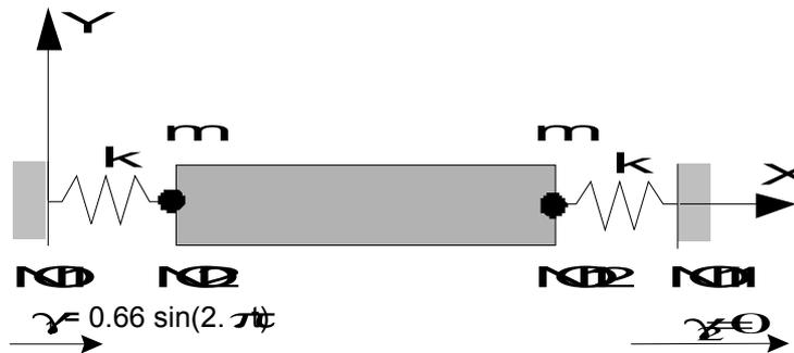
Figure 3.1-a : Modélisation du dispositif anti sismique
