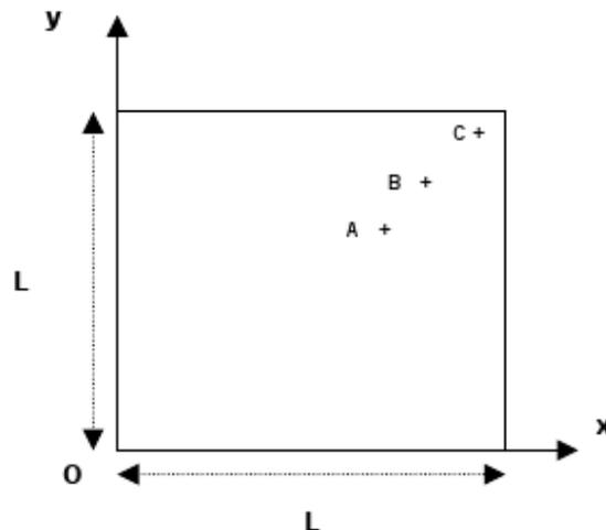
Il s'agit d'un barreau infini à section carrée de coté  $L=0.05\text{ m}$ .
