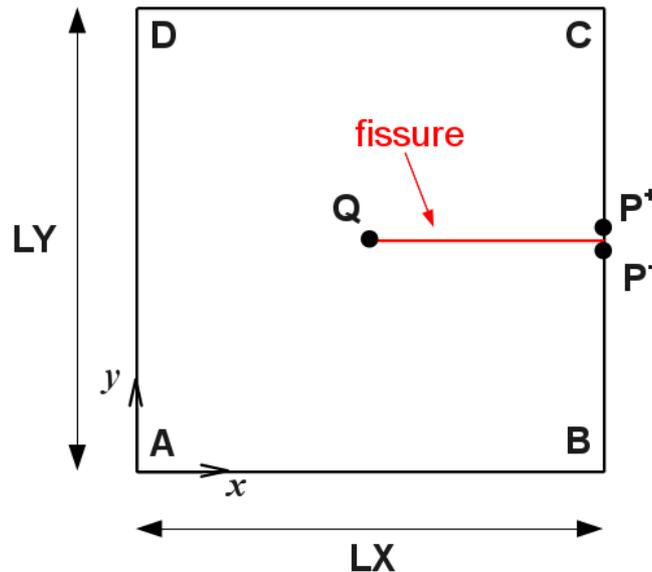
Figure 1.1-a: Géométrie de la plaque carrée fissurée
