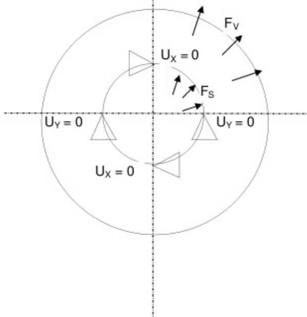
**Figure 1.3-a : Conditions aux limites et chargements**
