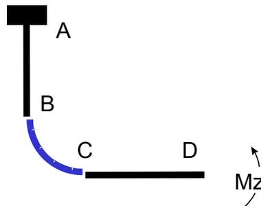
La section tubulaire a pour rayon moyen  $R = 105.5 \text{ mm}$  et pour épaisseur  $e = 8.18 \text{ mm}$
