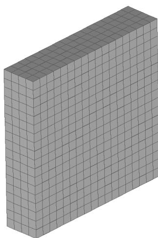
Figure 4.2-a: maillage utilisé pour définir la grille auxiliaire
