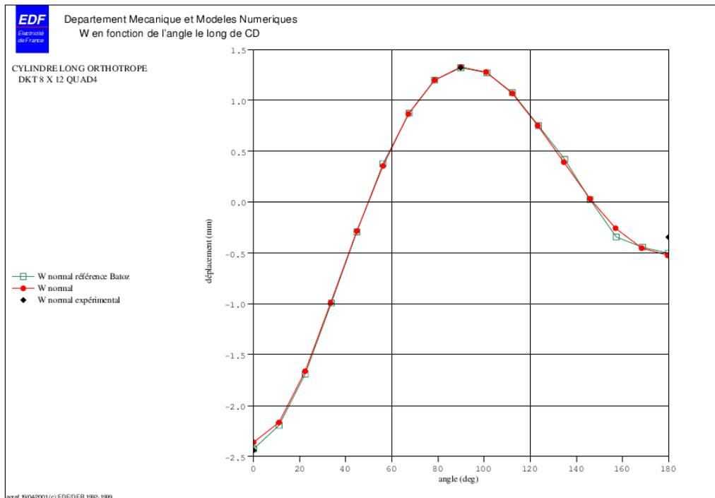
On peut noter qu'au-delà de l'écart observé sur la valeur expérimentale au point  $D$ , le déplacement normal calculé le long de  $CD$  est très proche de la solution en théorie « coques profondes » adoptée par Batoz [bib1].
