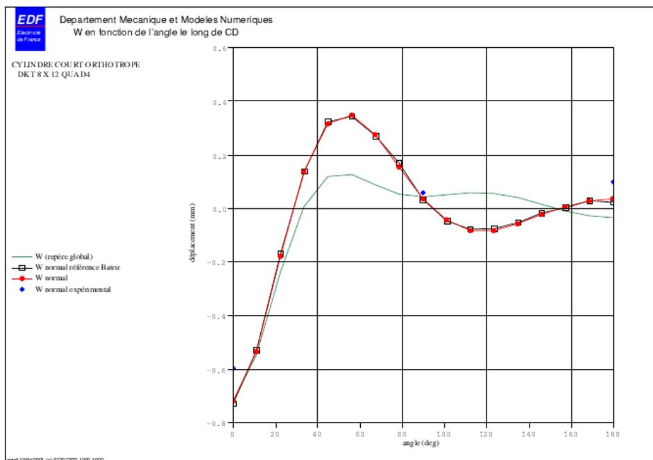
On peut noter qu'au-delà des écarts observés sur les points testés  $C$ ,  $F$ ,  $D$ , le déplacement normal calculé le long de  $CD$  est proche de la solution en théorie « coques profondes » adoptée par Batoz [bib1]. On peut imputer les erreurs relatives aux points  $F$  et  $D$  à la faible valeur du déplacement (de l'ordre de  $10^{-5} m$ ).
