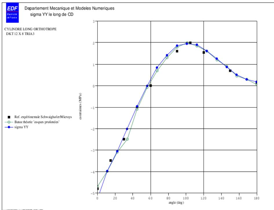
Les profils des contraintes calculées par le code sont globalement en accord avec les travaux de Batoz.
