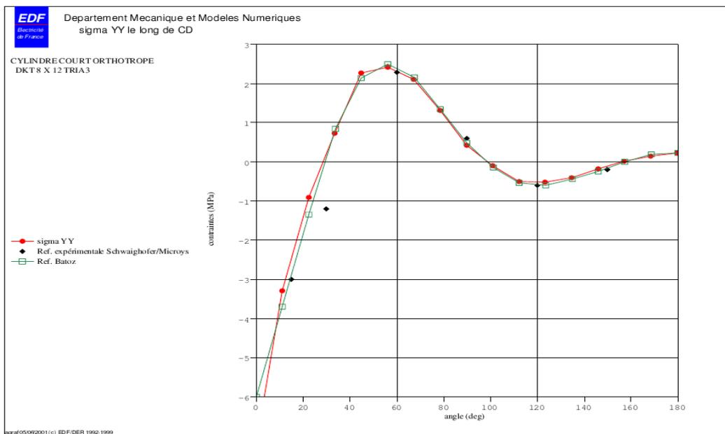
Les profils des contraintes obtenus par la modélisation B avec des TRIA3 sont dans l'ensemble proche des solutions de Batoz.
