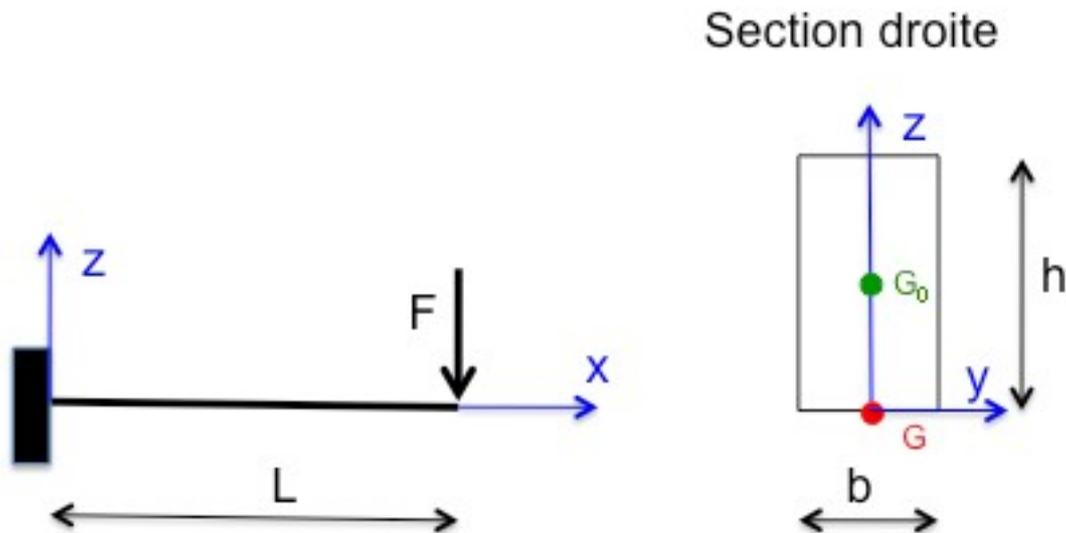
Figure 1 : Poutre console
