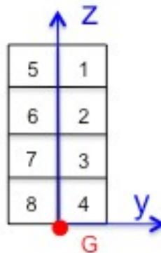
Figure 2 : Découpage de la section en 8 fibres
