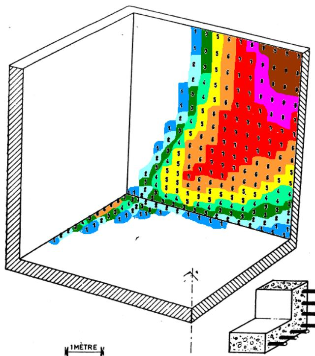
Fig. 16. — Cuve carrée en béton armé. Carte de ferrailage des aciers X extérieurs (en  $\text{cm}^2$  par mètre).
