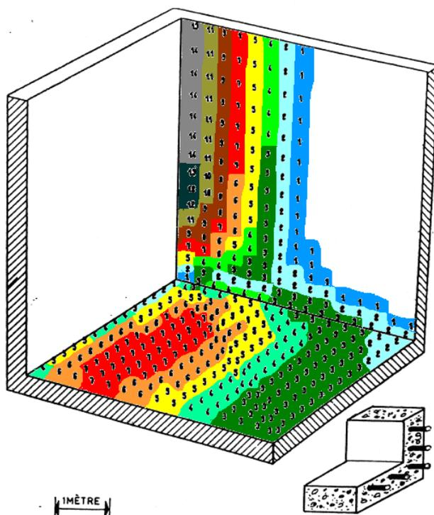
Fig. 19. — Cuve carrée en béton armé. Carte de ferrailage des aciers Y intérieurs (en cm<sup>2</sup> par mètre).
