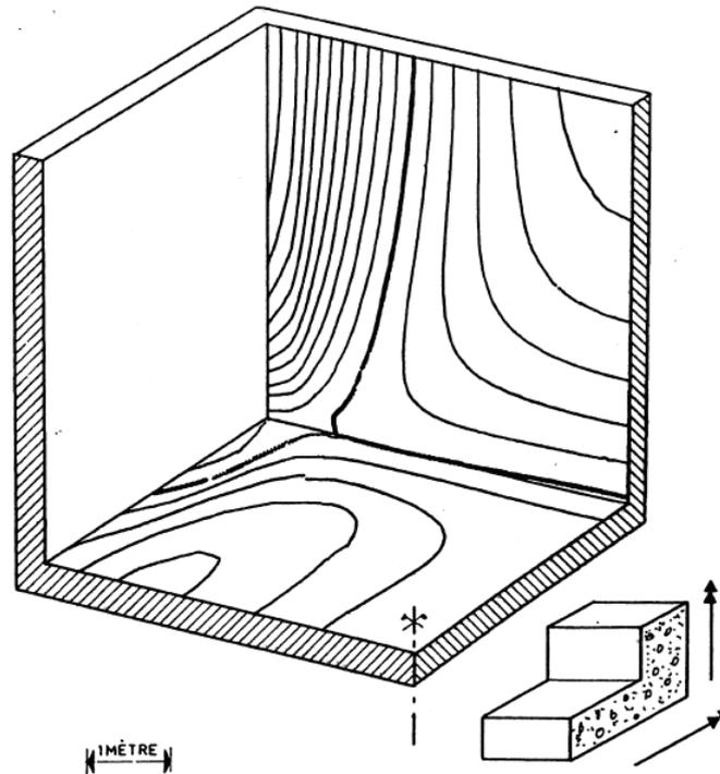
Fig. 15. — Cuve carrée en béton armé. Tracé des iso-moments  $M_{yy}$  (pas :  $10^6$  Nm par mètre).
