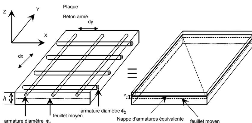
On note  $a_x = \frac{A_x}{d_x}$  et  $a_y = \frac{A_y}{d_y}$  les taux de ferrailage (ici :  $a_x = a_y = 7,854 \cdot 10^{-4}\text{ m}$ ),  $A_x$  ( $A_y$ ) étant l'aire de la section d'une barre de fer dans la direction  $x$  ( $y$ ) ;  $e_s$  est la distance des nappes à la surface moyenne.
