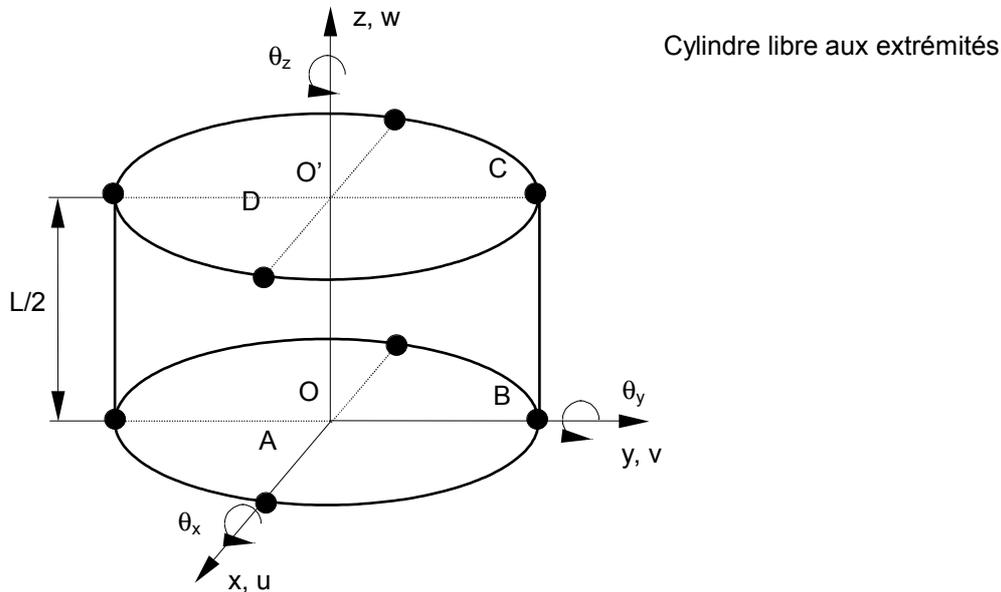
La symétrie du problème permet de modéliser un quart de cylindre de longueur  $L$ , avec des conditions de symétrie spécifiques au bord inférieur.
