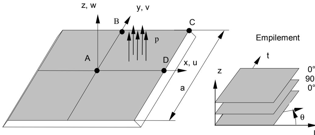
Largeur  $a=100\text{mm}$  , épaisseur  $h=1\text{mm}$  .
