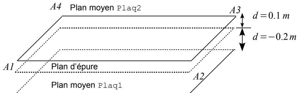
Les éléments utilisés sont des éléments de plaque DKQ.
