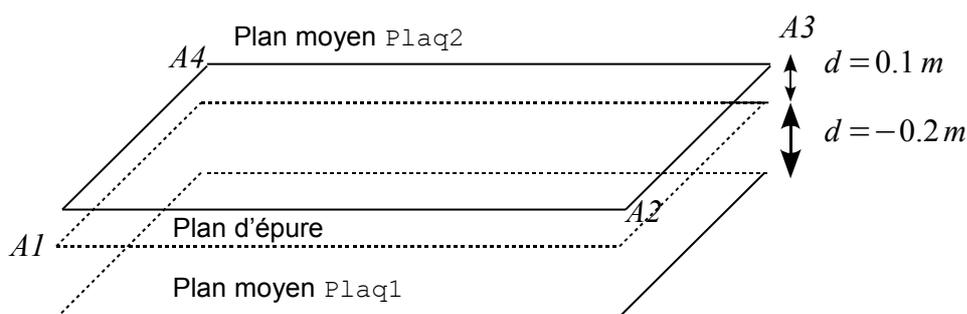
Les éléments utilisés sont des éléments de plaque DKT.
