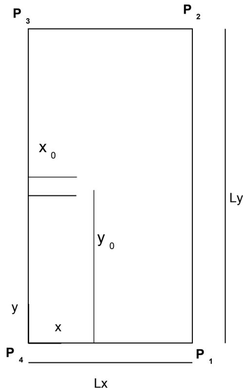
Figure 1.1-a : géométrie de la plaque fissurée
