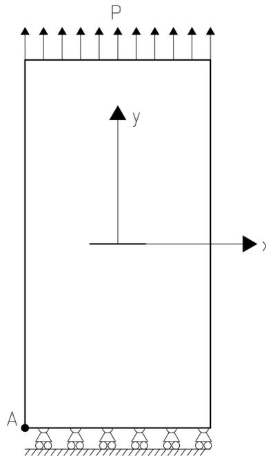
Figure 1.3-a: conditions aux limites et chargements
