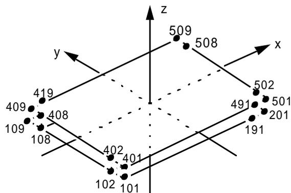
origines des axes = centre de la structure
