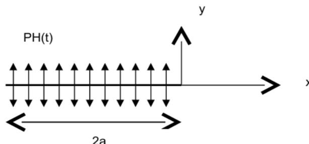
Il s'agit d'une fissure plane de demi-longueur  $a = 20\text{m}$ .
