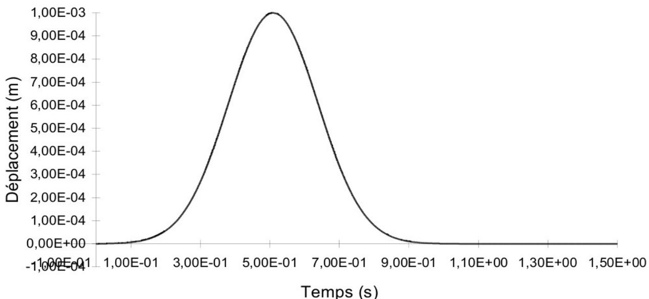
Comme prévu, la largeur du signal mesuré dans les deux cas est identique à celle de la fonction d'excitation. Physiquement, on observe bien la propagation de l'onde de compression. Le signal est peu modifié dans sa propagation et on retrouve donc bien l'amplitude maximale de 1 mm. On note également clairement le retour au repos immédiatement après le passage de l'onde et l'absence de signal réfléchi à l'extrémité du maillage.
