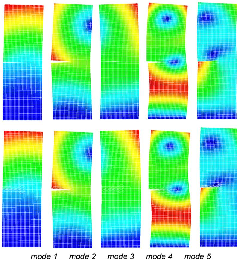
Figure 4 .5 - a: Les déformées modales pour les 5 premiers modes propres. Sur la rangée d'en haut sont les modes "classiques" et sur la rangée d'en bas ceux "X-FEM"
