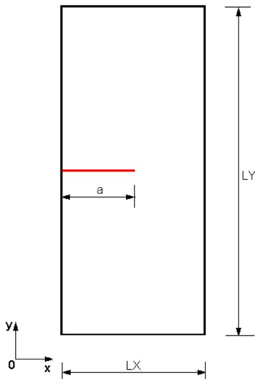
Figure -1.1-a : Géométrie de la plaque fissurée
