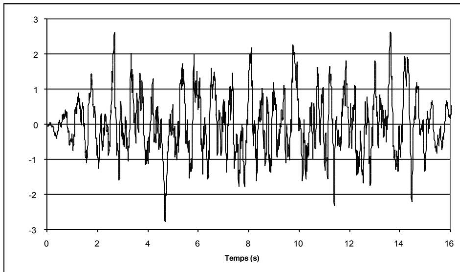
Figure 1.3-a : Accélérogramme ac\_s2\_c\_1 imposé à la structure
