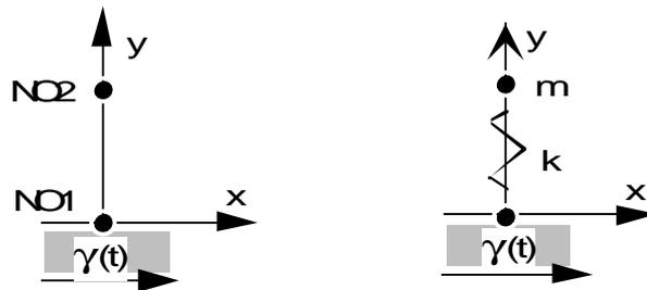
Le nœud `NO1` est soumis à une accélération imposée  $\gamma(t)$ . On calcule le déplacement relatif du nœud `NO2` par rapport au déplacement du nœud `NO1` et on le compare au déplacement calculé analytiquement.
