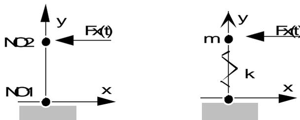
Le nœud `NO2` est soumis à une force imposée  $F_x(t)$ . On calcule le déplacement relatif du nœud `NO2` par rapport au déplacement du nœud `NO1` et on le compare au déplacement calculé dans les références [bib1] et [bib2].
