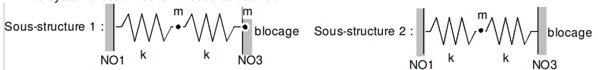
En situation, les deux sous-structures sont reliées au niveau de la 2<sup>ème</sup> masse. L'interface dynamique de la 1<sup>ère</sup> sous-structure est constituée d'une masse  $m$  au niveau du nœud  $NO3$  du maillage et coïncide avec l'interface dynamique de la 2<sup>ème</sup> sous-structure qui ne comporte aucune masse et est simplement bloquée au niveau du nœud  $NO1$ .
