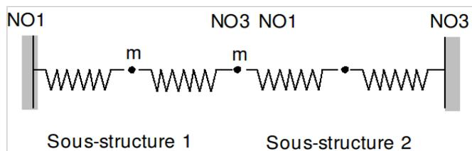
Les modes propres du système complet sont calculés en utilisant la méthode de calcul modal par sous-structuration avec interfaces de type 'Craig-Bampton' (interfaces bloquées). Les bases de chaque sous-structure sont composées d'un mode dynamique et d'un mode contraint.
