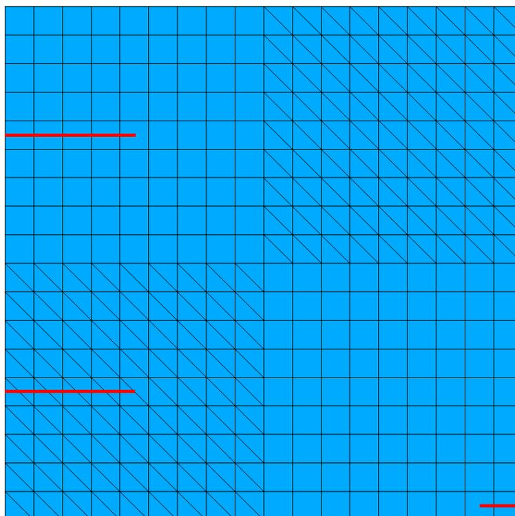
Figure 3.1-1: maillage B et localisations des fissures
