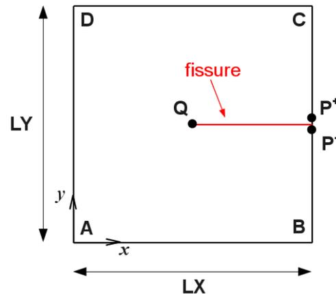
Figure 1.1-2: Géométrie de la plaque avec fissure fictive
