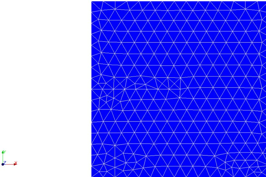
Il est composé de 296 nœuds pour 513 éléments TRIA3. Le fond de fissure est composé d'un seul nœud situé aux coordonnées  $(0.5, 0.5)$ .
