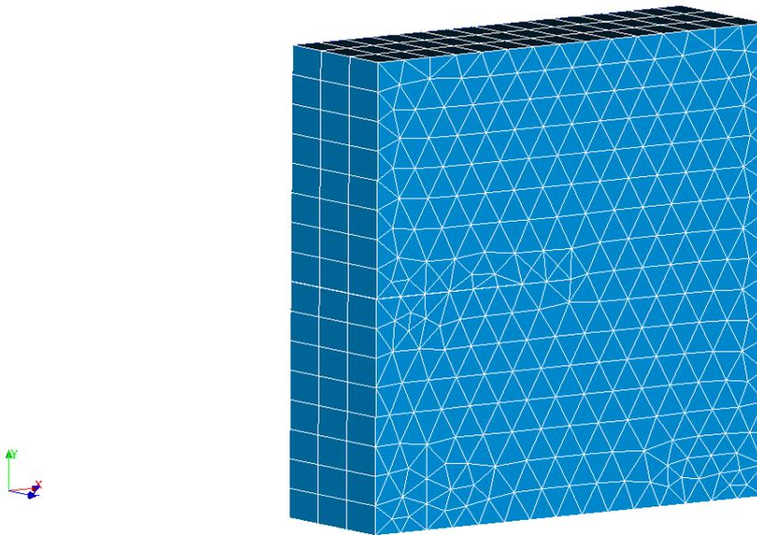
Il est composé de 1184 nœuds pour 1539 éléments volumiques PENTA6. Le fond de fissure est composé de 4 nœuds situés le long de l'axe  $z$  en  $x=0.5$  et  $y=0.5$ .
