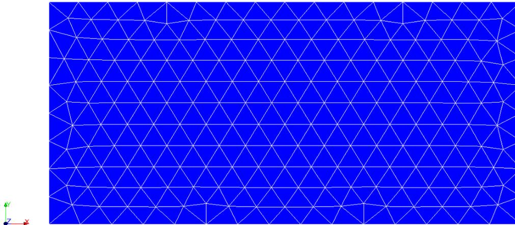
Il est composé de 222 nœuds pour 395 éléments `TRIA3`. Le fond de fissure est composé d'un seul nœud situé aux coordonnées  $(0.5, 0.5)$ .
