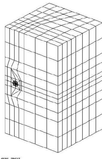
Il est composé de 5527 nœuds, de 784 éléments volumiques HEXA20 et 432 PENTA15. Le fond est un quart de cercle dans le plan  $Oxy$  composé de 17 nœuds.
