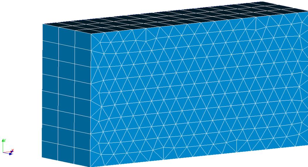
Il est composé de 888 nœuds pour 1185 éléments volumiques `PENTA6`. Le fond de fissure est composé de 4 nœuds situés le long de l'axe  $z$  en  $x=0.5$  et  $y=0.5$ .
