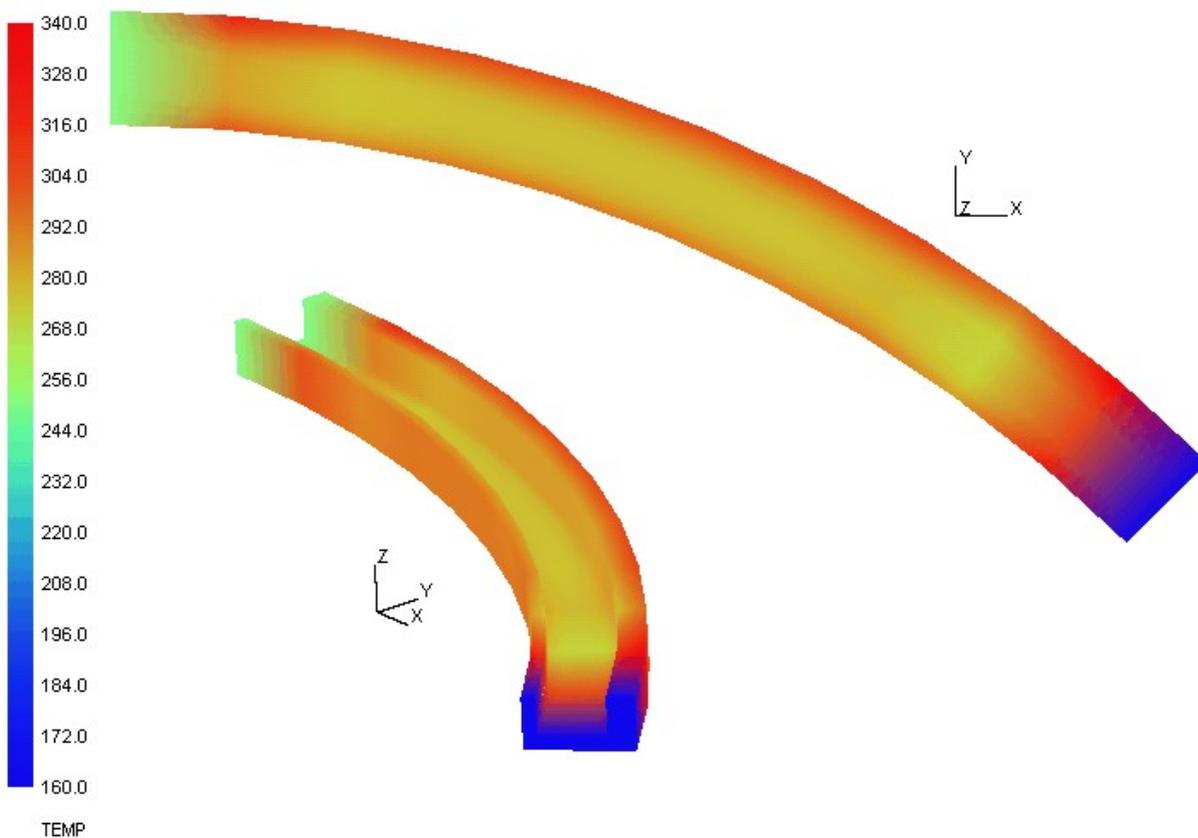
Figure 2.2-a : Champ de température calculé sur 1/8<sup>ème</sup> de la structure.
