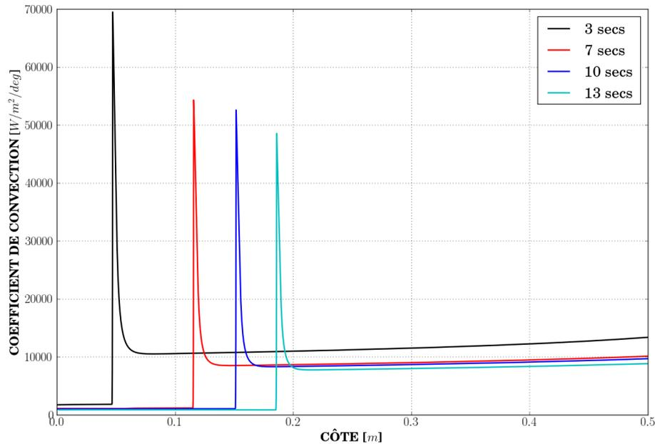
Figure 4.3-1: Coefficients de convection à plusieurs instants d'un calcul avec condensation de la vapeur.
