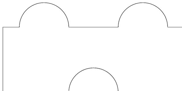
La mauvaise solution est celle-ci : repérer les mailles des bords courbes et les stocker toutes dans le même groupe. HOMARD ne sait pas gérer un bord fractionné ; il y aura arrêt avec un message signifiant que la ligne est en plusieurs morceaux.
