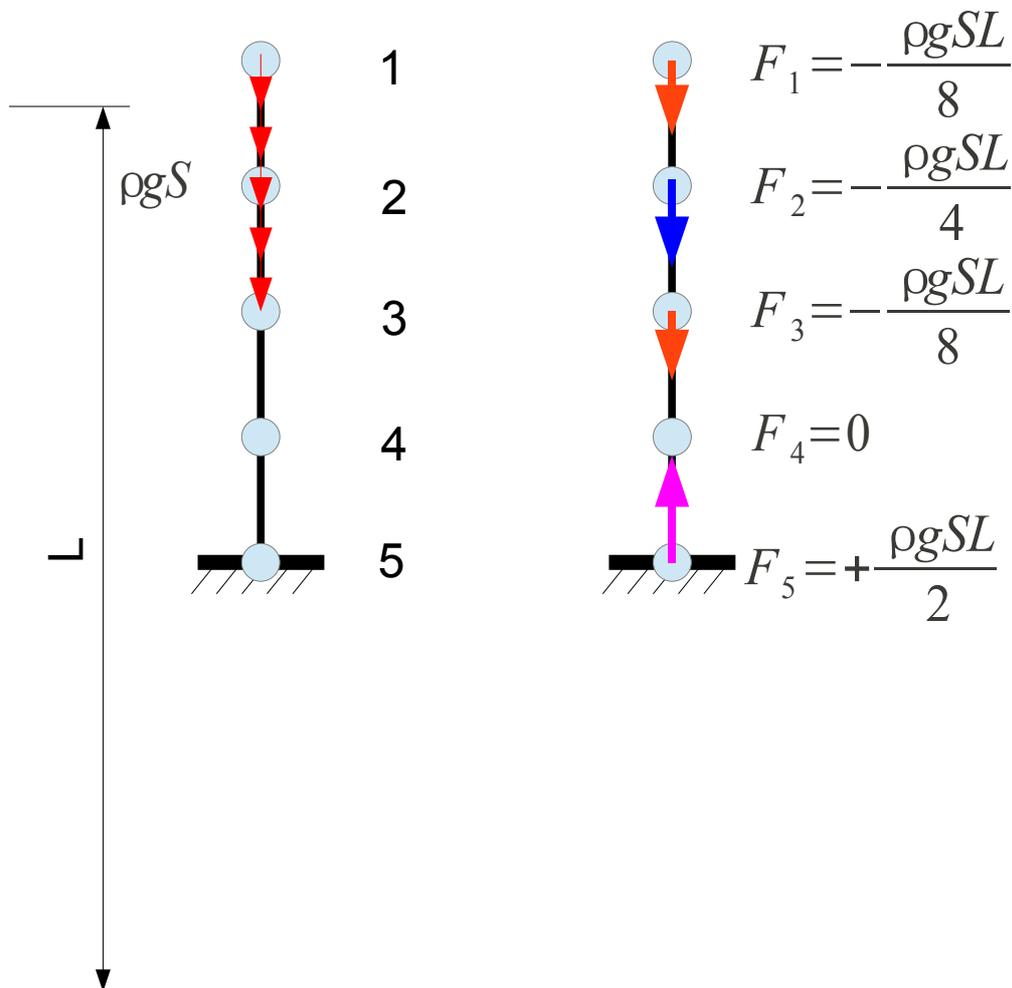
Figure 2.9.4-1: structure sous chargement réparti (gauche), FORC\_NODA (droite)
