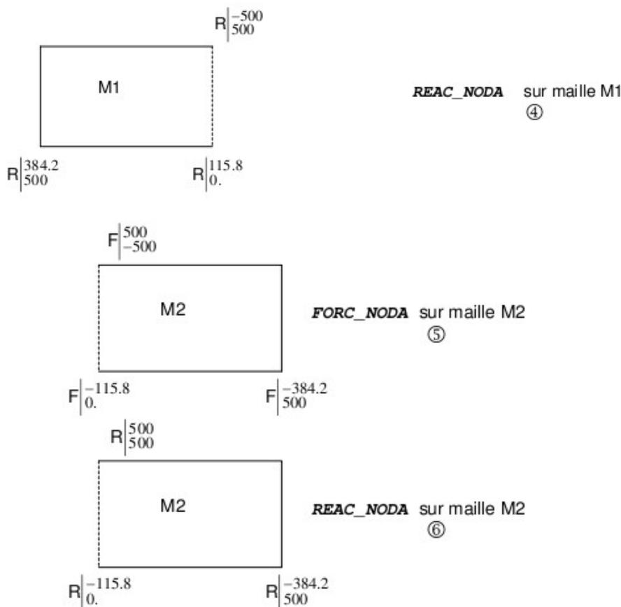
Sur cet exemple, les réactions aux nœuds (2) sont bien égales aux forces nodales (1) moins le chargement. Elles représentent les réactions aux appuis de la structure.
