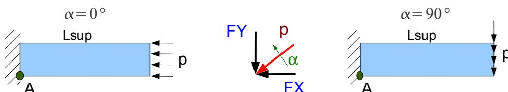
Les calculs seront effectués tous les  $22.5^\circ$ , pour un angle  $\alpha$  variant de  $0^\circ$  à  $90^\circ$ . Le nombre de scénarios de calcul à réaliser est donc de 5. Dans le tableau ci-dessous nous présentons les valeurs que vont successivement les paramètres  $FX$  et  $FY$ .
