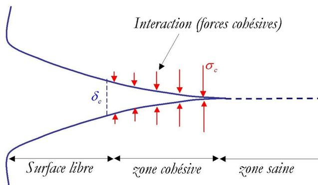
Figure 3.3 : Schéma de la fissure cohésive.
