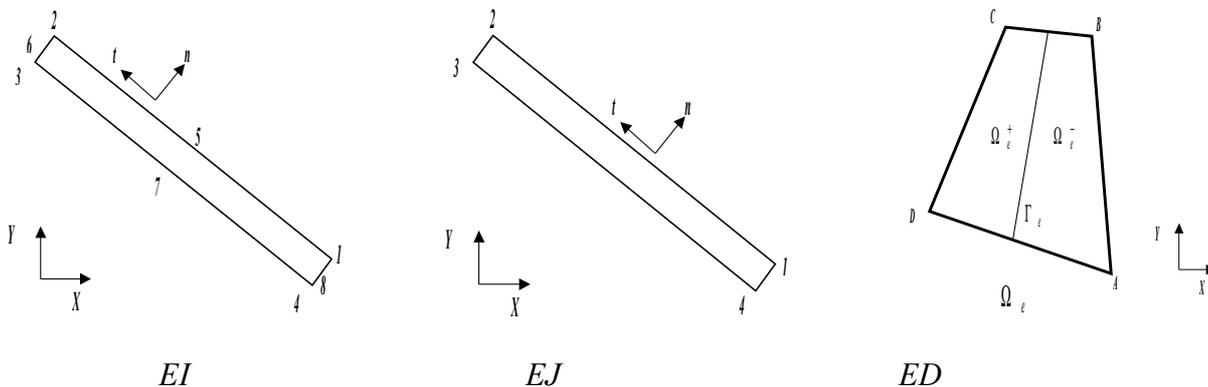
Figure 3.1-b : Schéma 2D des éléments cohésifs
