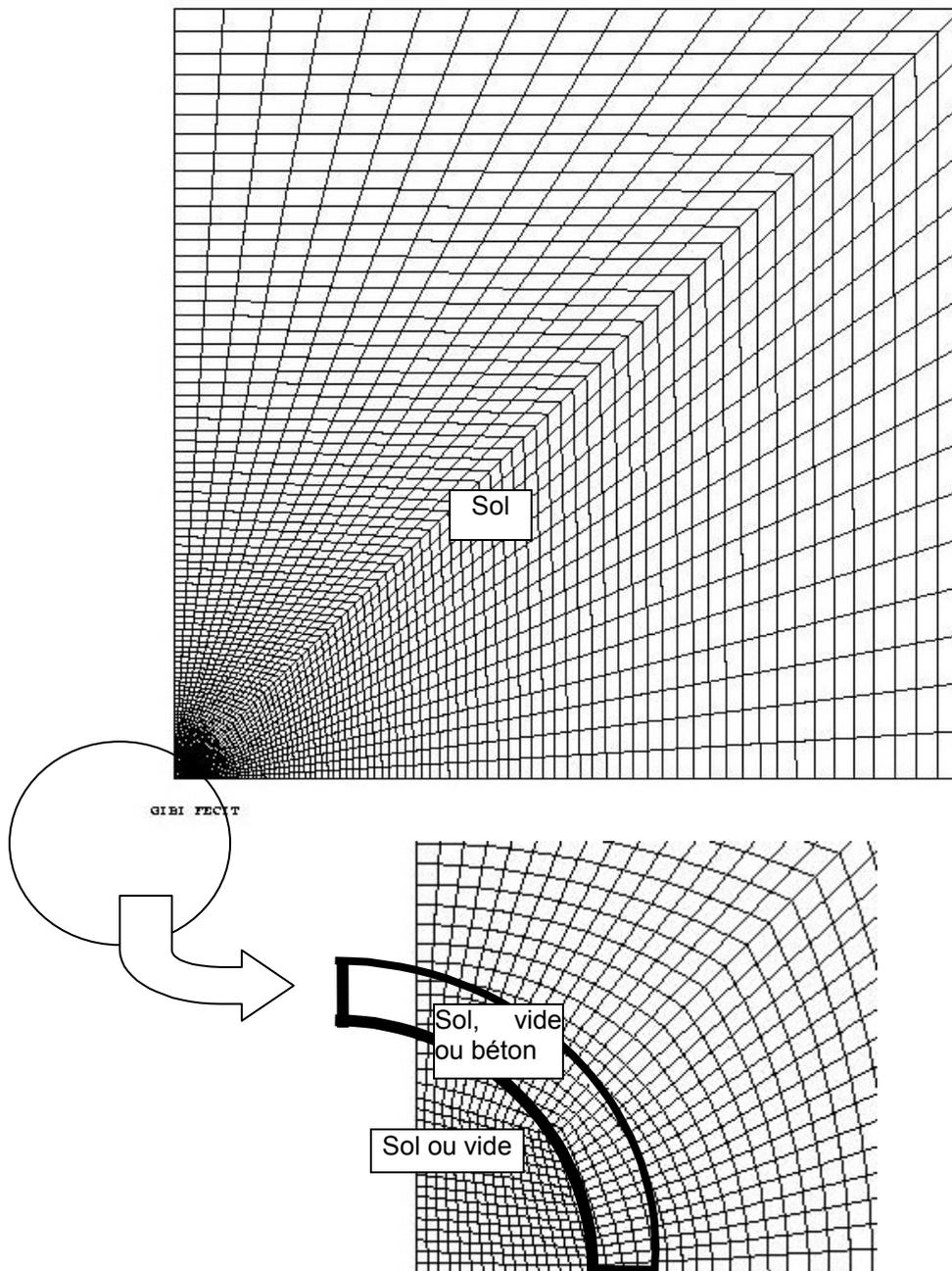
Figure 4.1-a : Maillage utilisé et matériaux
