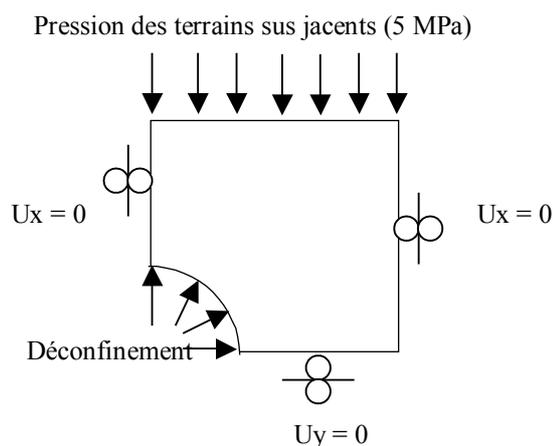
Figure 5.1-a : Conditions aux limites et chargement imposés
