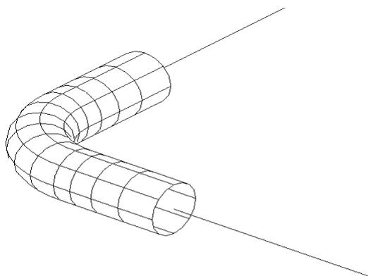
Figure : Exemple de liaison entre un maillage COQUE\_3D et TUYAU.
