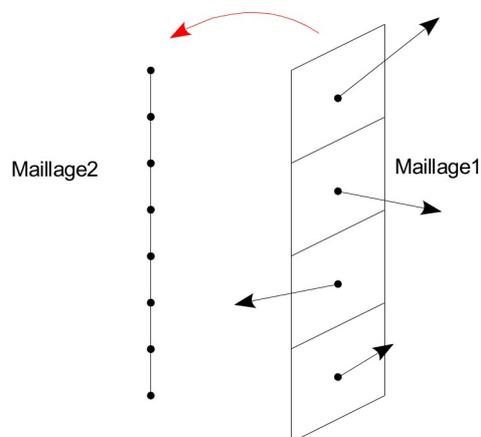
Pour que la technique présentée ici fonctionne, il suffit simplement que les maillages soient parallèles l'un à l'autre (par exemple, il faut qu'ils soient tous les deux suivant l'axe z) et qu'ils aient une plage de coordonnées en commun suivant l'axe suivant lequel ils sont parallèles.
