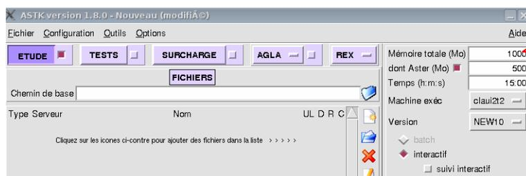
Figure 5.2-b : Paramétrage dans Astk de la mémoire RAM.
