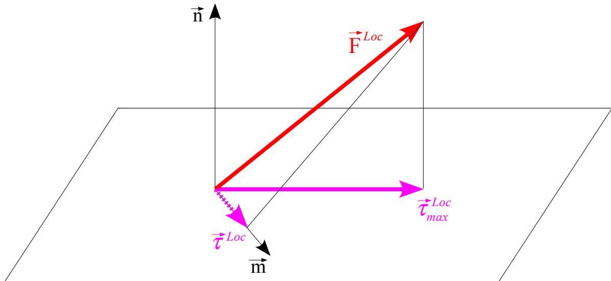
Figure 3.2-a : Projection de  $F^{Loc}$  sur le plan de normale  $n$
