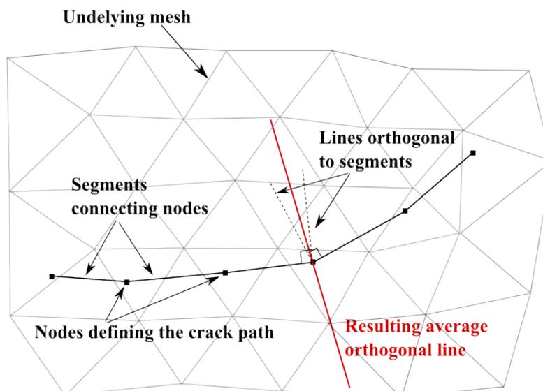
Figure 4: normale moyenne au trajet de fissuration pour le calcul de l'ouverture de fissure.
