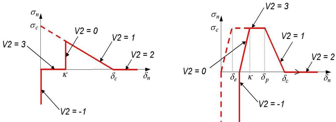
Figure 13 : Représentation des valeur de l'indicateur V2 pour les lois CZM\_OUV\_MIX à gauche et CZM\_TRA\_MIX à droite
