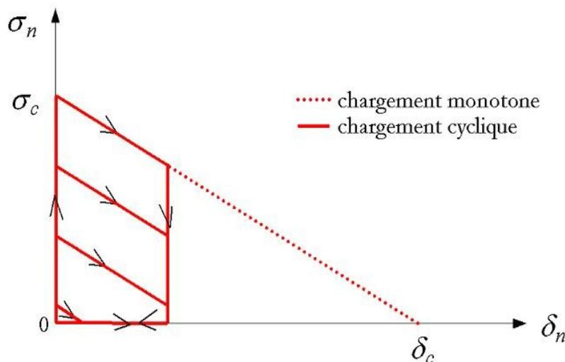
**Figure 12 : Evolution de la contrainte au cours de chargements monotone et cyclique avec le loi CZM\_FAT\_MIX**
