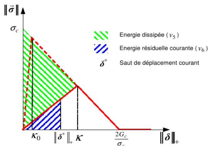
Figure 5 : Représentation des énergies pour la loi CZM\_LIN\_REG.
